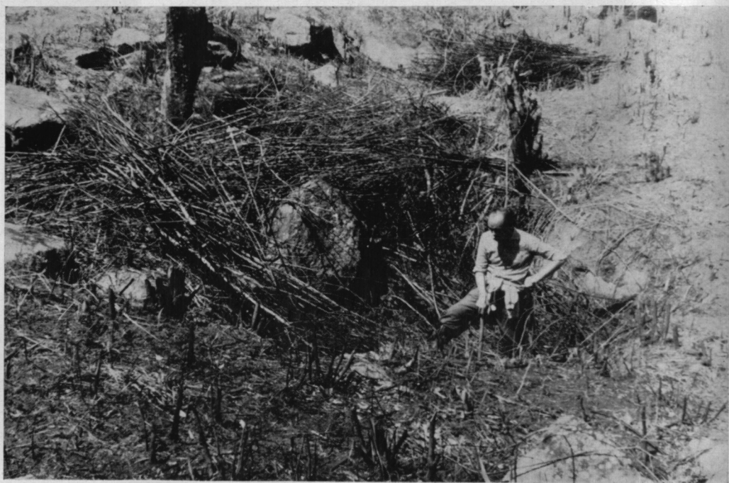
Fig. 3. — Un entonnoir plus vaste fait apparaître ici une zone déprimée encombrée des blocs déchaussés par la succion du sable par les écoulements souterrains. Le point le plus actif se trouve au niveau du personnage qui en donne l'échelle (il s'agit du point E de la figure 1).
