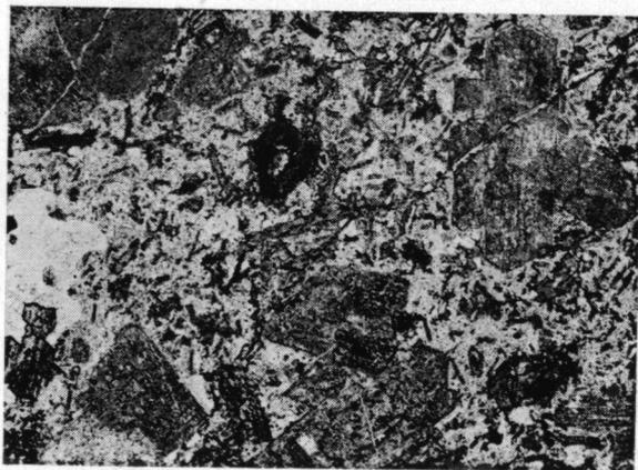
Fig. 14. — *Microdiorite de Peyre Arguet*. Pilatte (lumière naturelle, X 20). Le quartz corrodé, les grandes oligoclases séricitisées et les amas chloriteux se détachent du fond quartzofeldspathique engrené (échantillon 403).
