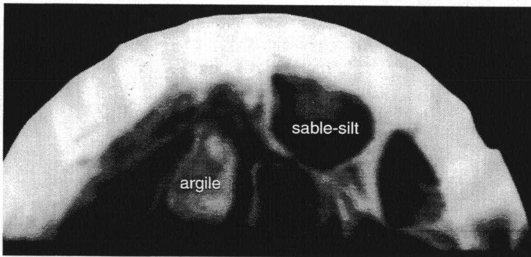
FIG. 2. – Structure de liquéfaction type multi-circulaire (plan horizontal) ;
