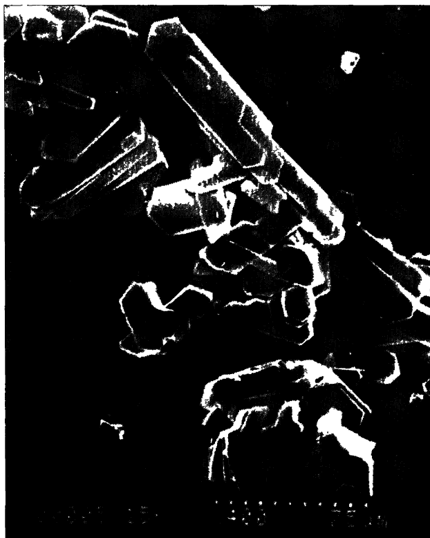
Fig. 3 : Dickite montrant les formes sub-hexagonales et pouvant dépasser 50 μm (x 400).
