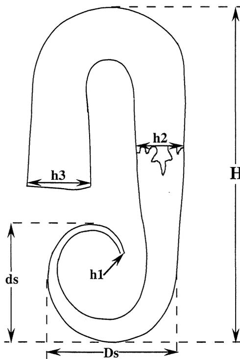
FIG. 1 – Schéma théorique montrant les mesures effectuées.
