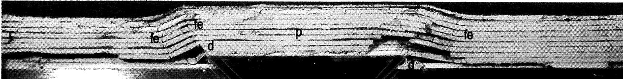
FIG. 3. – Expérience 2, contexte compressif, fonctionnement des failles de socle chevauchant, charge 20 kg.
